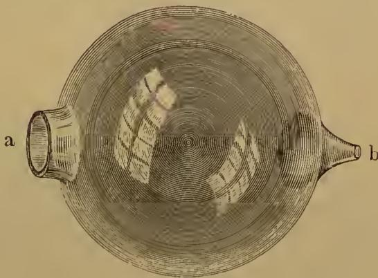
Figur 264. Resonator, nach Helmholtz.
